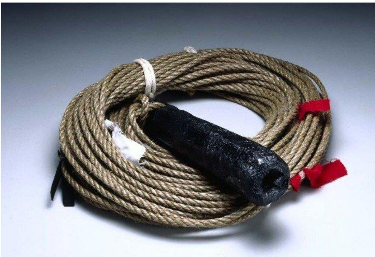
Конструктивно **ЛОТ ручной** состоит из гири и прикрепленному к нему лотлиню с бухтой, длина лотлиня зависит от массы груза.
