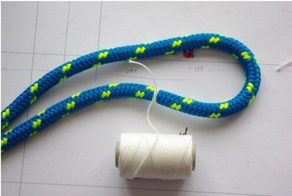
Затем накладывают на оба троса 10-15 шлагов. Далее, пропустив ходовой конец нити между скрепляемыми тросами, двумя шлегами накладывают крыж.
