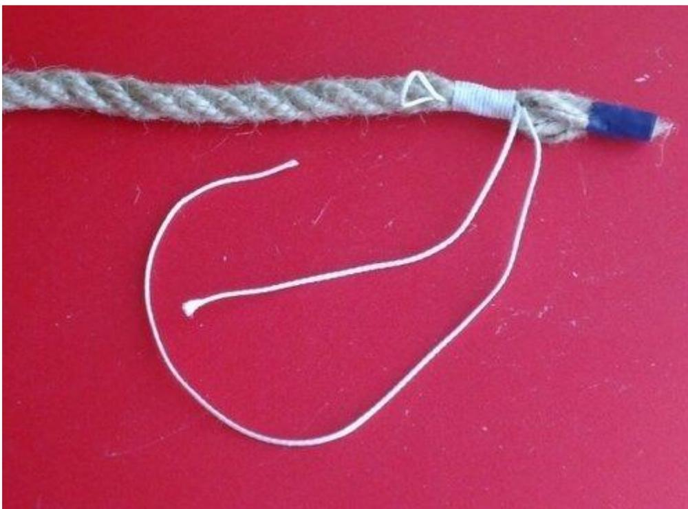
Коренной (короткий) конец нити уложим вдоль троса между прядями и поверх него ходовым (длинным концом) туго наложим шлаг марки. Ходовой конец закрепим пробив его под одной из прядей троса с таким расчётом, чтобы он выходил наружу в том же месте что и коренной...
