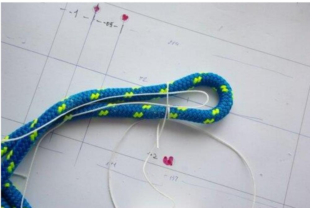
Затем, туго, виток к витку накладывается 10-15 шлагов нити. Далее, той же нитью поверх них накладывается ещё ряд шлагов до края бензеля. Второй (внешний ряд шлагов) обтягивается чуть слабее. Это нужно для того чтобы избежать деформации и ослабления бензеля.
