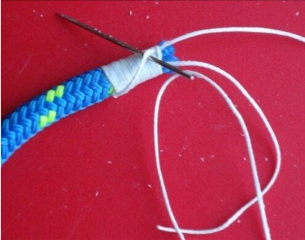
С помощью иглы проведём ходовой конец нити под первым (противоположным) шлагом марки немного в стороне от места его выхода из петли, затем под собою же... Образовав таким образом, полуштык, и несильно обтянем.
