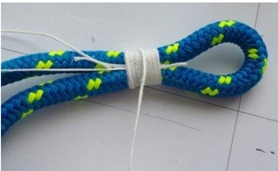
Ходовой конец нити пропускается в петлю проводника и втягивается под бензель..
