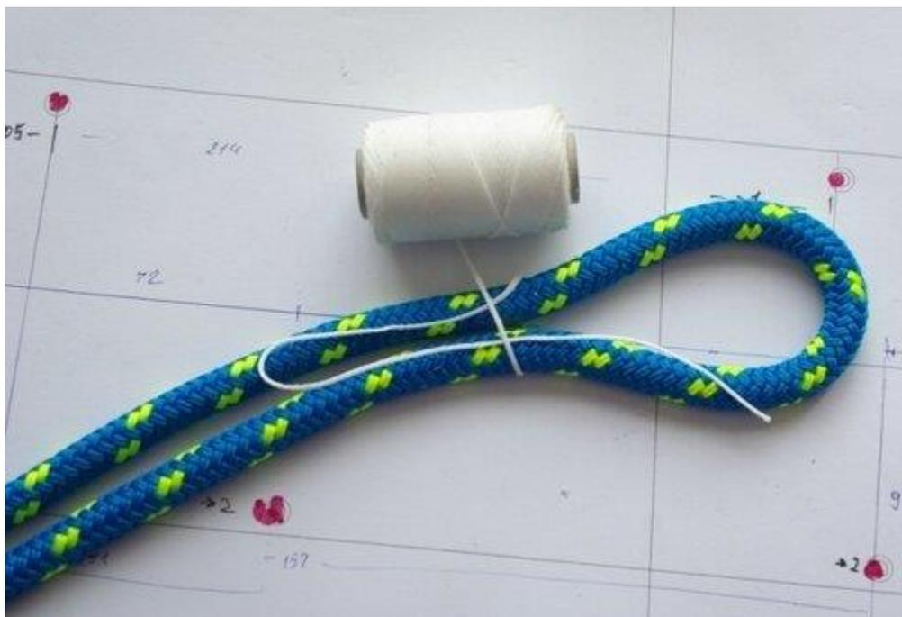
Техника выполнения прямого (круглого) бензеля несколько иная. Вдоль скрепляемых тросов укладывается "проводник" - сложенный вдвое отрезок нити и её коренной конец.
