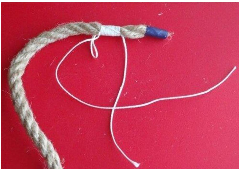
Далее уложим его поверх марки между прядями и пробьём под прядью. Здесь нужно учесть, что последний шлаг должен прийти в место выхода из марки затягивающей петли. Поэтому при пробивке ходового конца нити его нужно провести так, чтобы он вышел наружу не в том месте что и затягивающая
