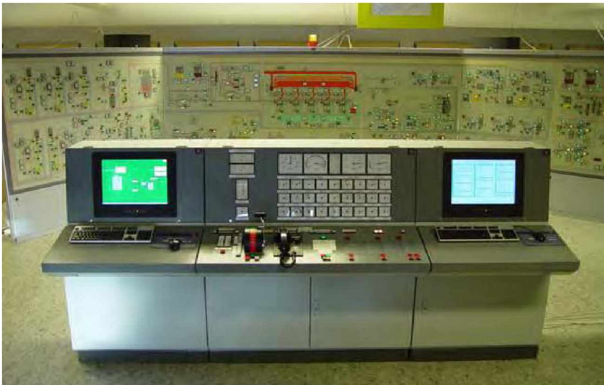
Рис.1. Общий вид тренажера машинного отделения
