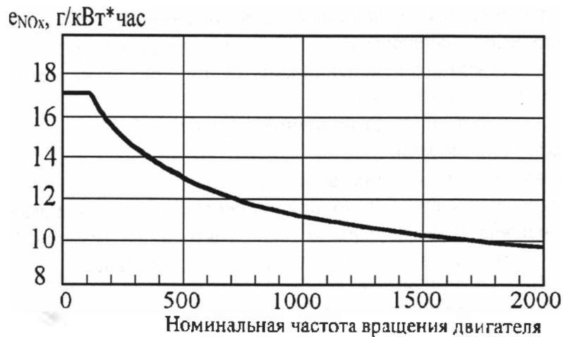
Рис.3. Зависимость допустимой величины *средневзвешенного* удельного выброса NOx от частоты вращения двигателя (измерения  $e_{NOx}$  должны проводиться в соответствии с международным стандартом ISO 8178 – испытательные циклы E2/E3/D2)
