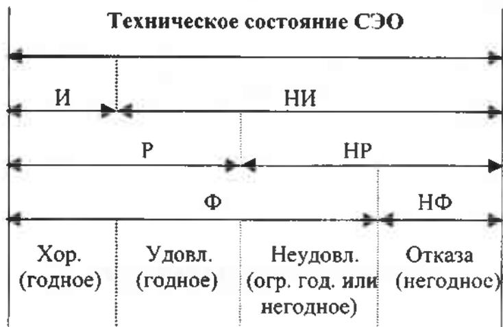
Рис. 3. Виды технического состояния СЭО
