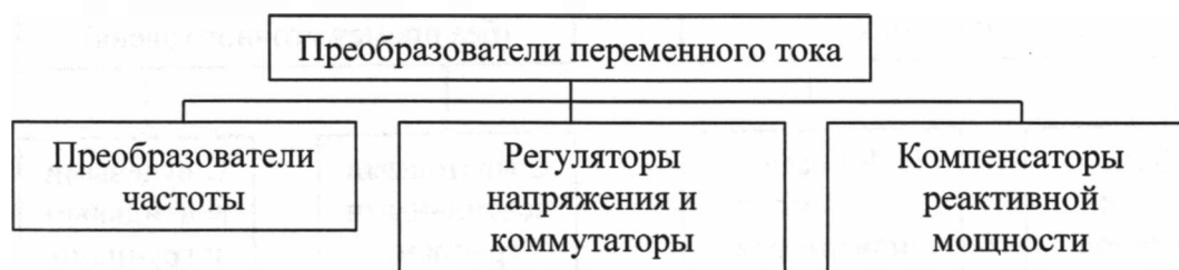
Рис. 31. Классификация преобразователей переменного тока по функциональному назначению
