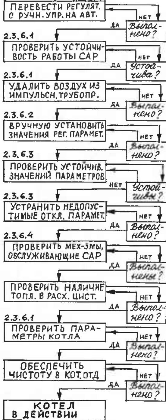
Рис. 10. Включение котла в работу
