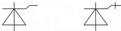
Рис. 7. Обозначение однооперационного (незапираемого) и двухоперационного (запираемого) тиристора
